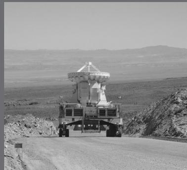
専用台車に載せられて運搬中のアルマ望遠鏡7mアンテナ。厳しい自然環境と人工物のせめぎあいも美しさを醸し出す、気がします。
